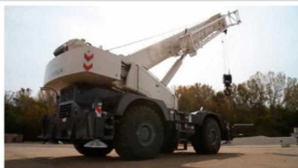
**Макс. Грузоподъёмность / Max. Tragkraft / Max. Capacity: 100 t / bei Radius 3 m**
